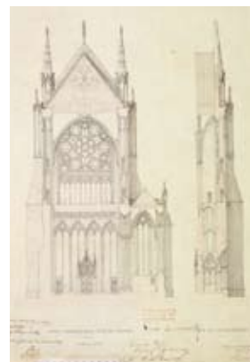
Projet de restauration du pignon du bras nord du transept, élévation intérieure et coupe transversale, Victor Ruprich-Robert, 1857 (ministère de la Culture, médiathèque de l'architecture et du patrimoine)
